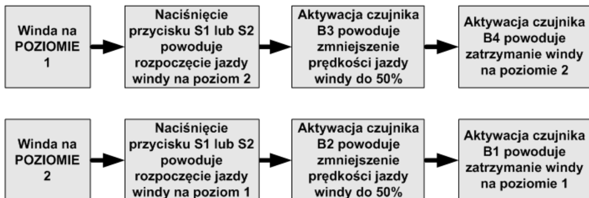
Rysunek 2. Diagramy działania programu sterowania windą
