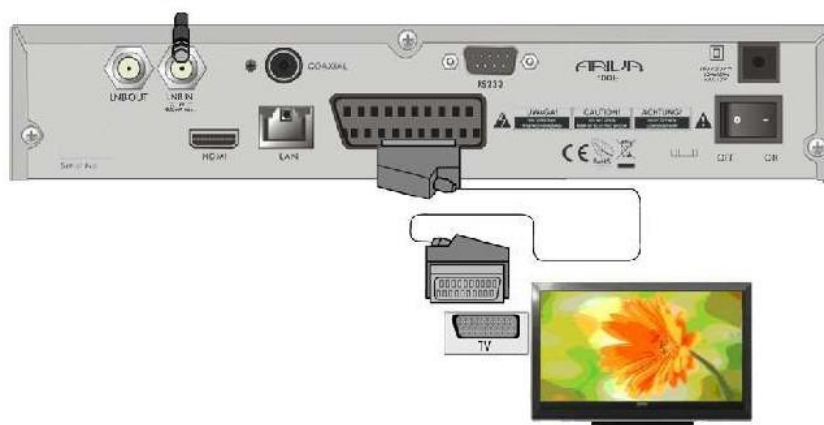
Rysunek 1. Schemat połączenia tunera satelitarnego z OTVC:
