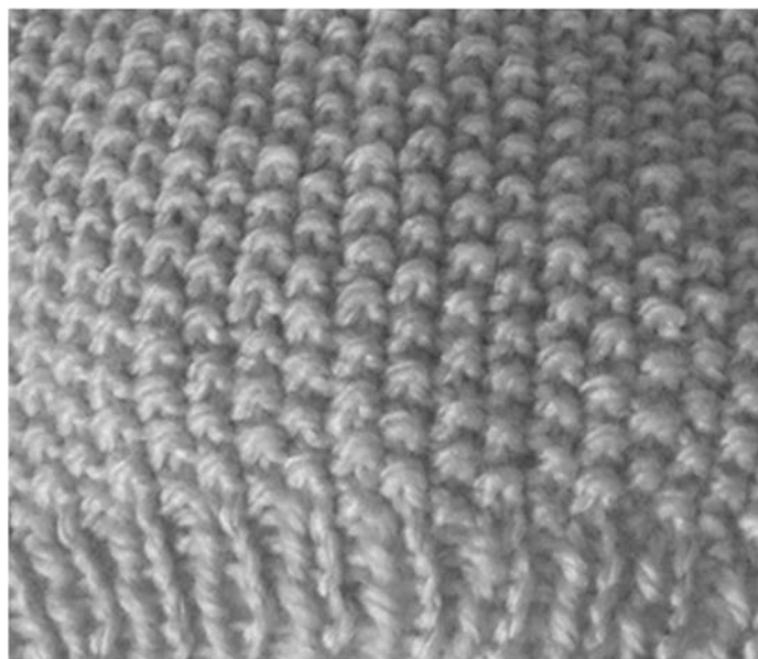
próbka dzianiny wykonanej splotem ryżowym
