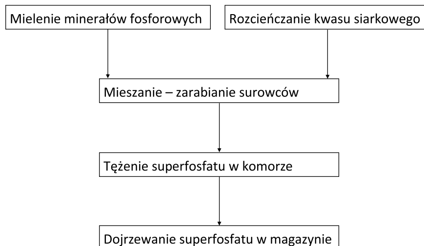
Rysunek 1. Schemat ideowy produkcji superfosfatu prostego
