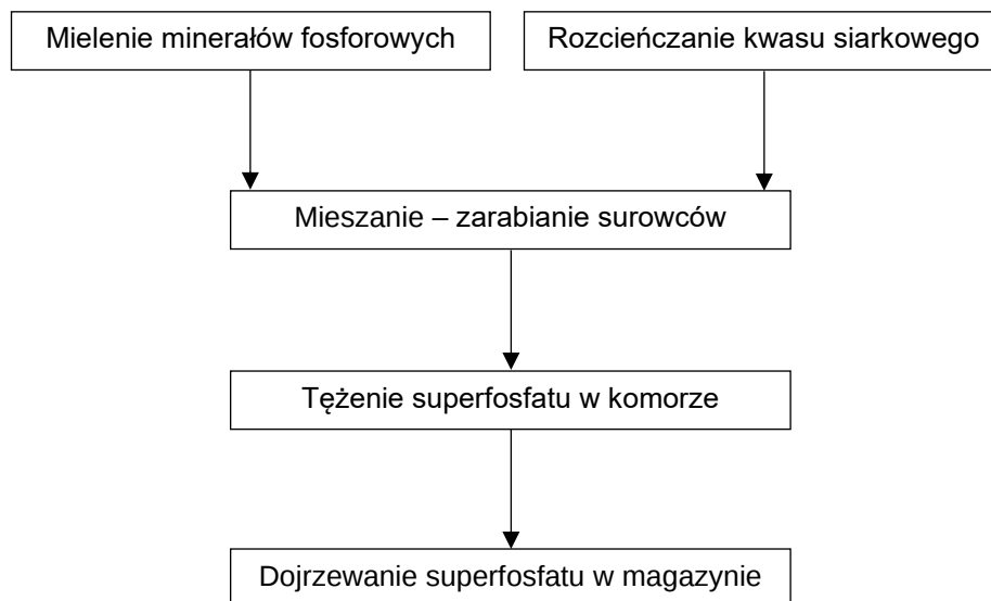
Rysunek 1. Schemat ideowy produkcji superfosfatu prostego
