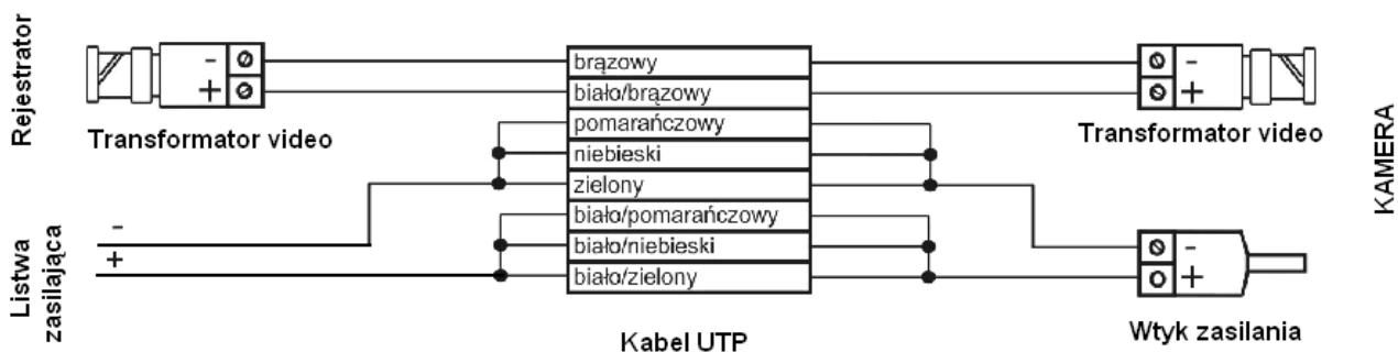
Rysunek 4. Schemat połączenia kamery z rejestratorem poprzez pasywny transformator video
