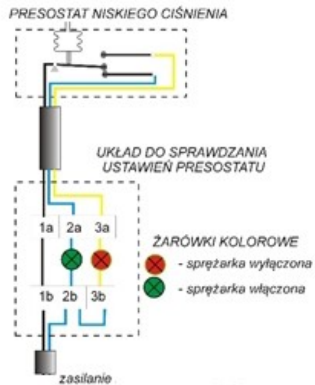
Rysunek 3. Schemat podłączenia układu do testowania presostatu.
