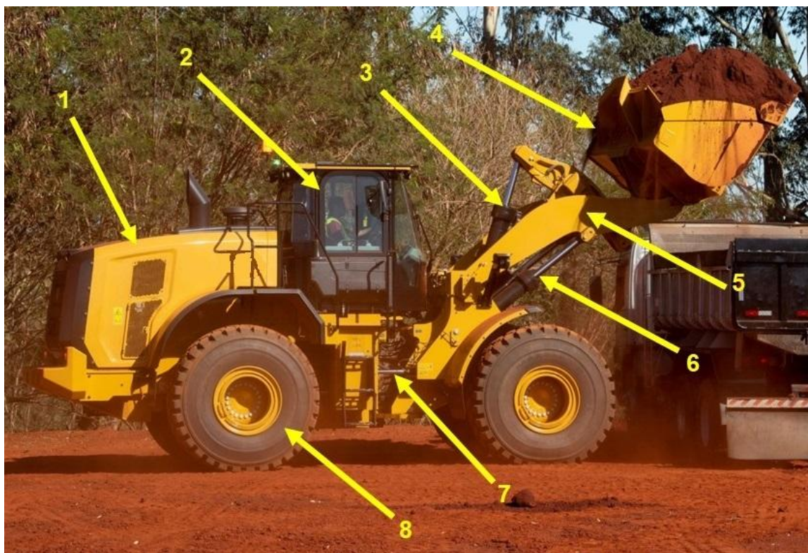
Rysunek 2. Elementy budowy ładowarki kołowej
