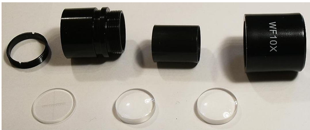
Rysunek 2. Zespół okularu mikroskopowego w rozbiorze na części.
