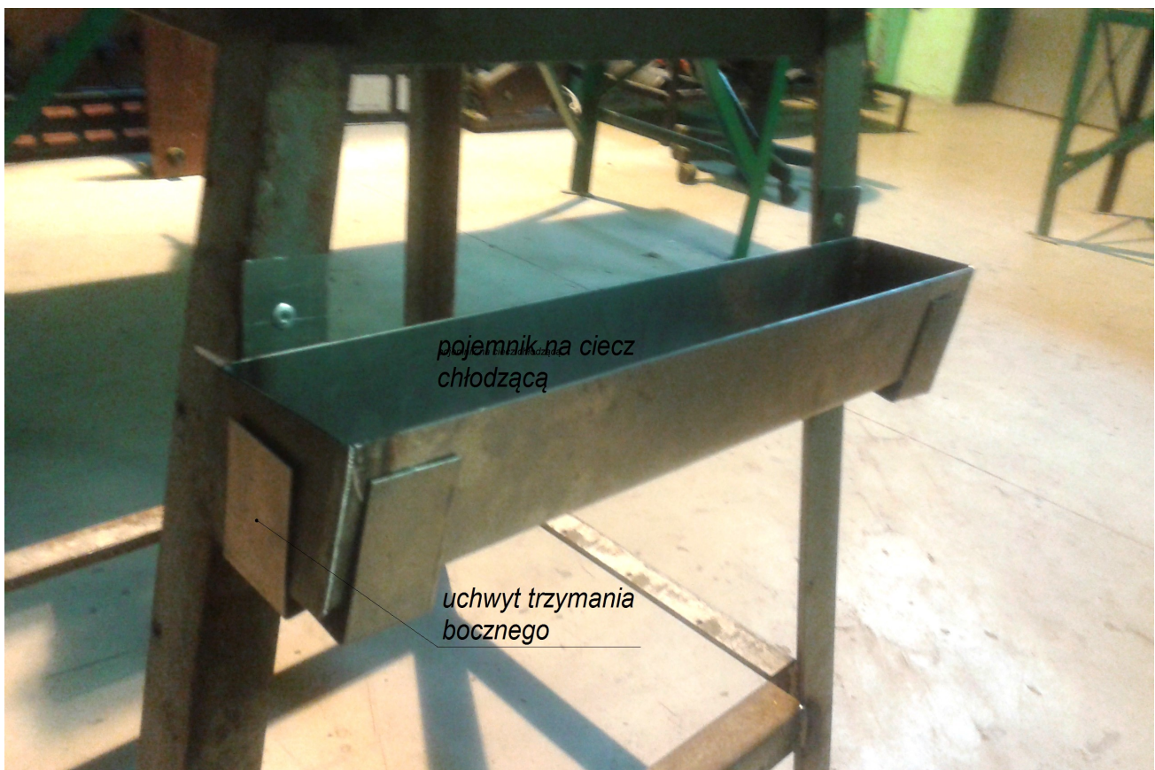
Rysunek 1. Widok bocznego uchwytu wraz z pojemnikiem na ciecz chłodzącą
