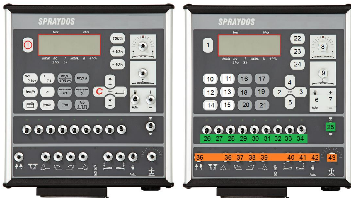
Rysunek 5. Oznaczenie przycisków komputera
