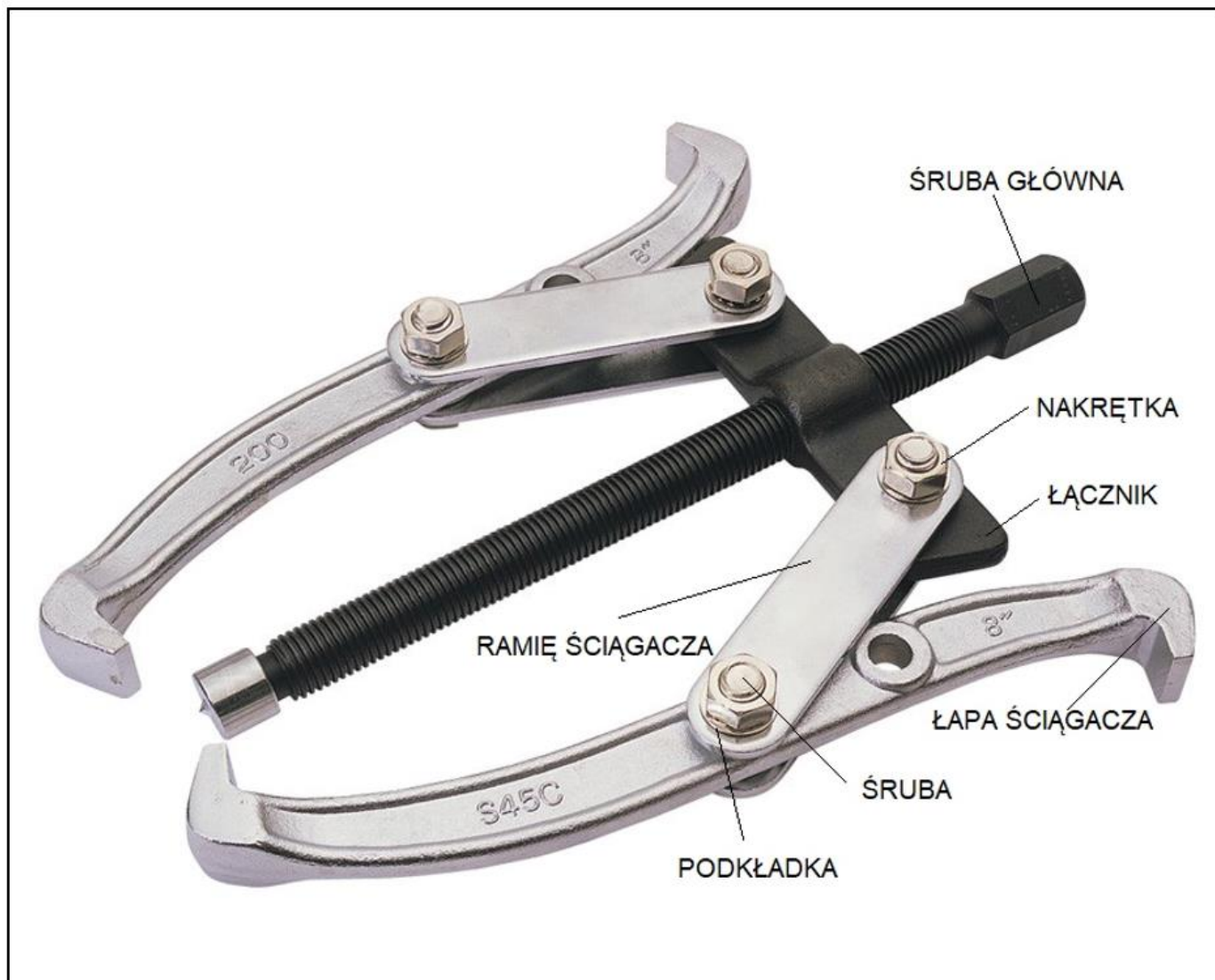
Rysunek 1. Ściągacz do łożysk
