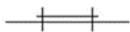
Rysunek 10. Łączenie taśmy samoszczepnej Velcro z materiałem za pomocą szwu łączącego zwykłego
