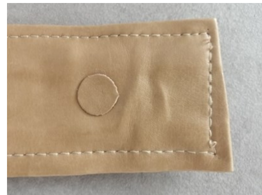
Ilustracja 5. Maskowanie podstawy nita
