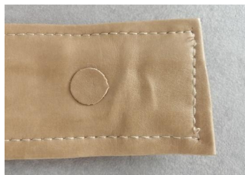
Ilustracja 5. Maskowanie podstawy nita
