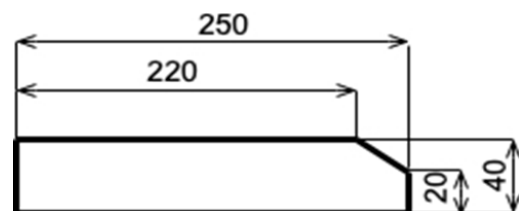
Rysunek 3. Szablon paska zapinającego (taśma gurtowa)
