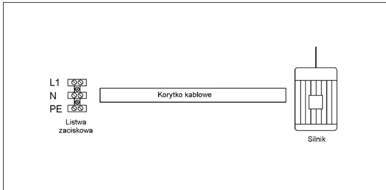
Rysunek 2. Rozmieszczenie elementów układu elektrycznego
