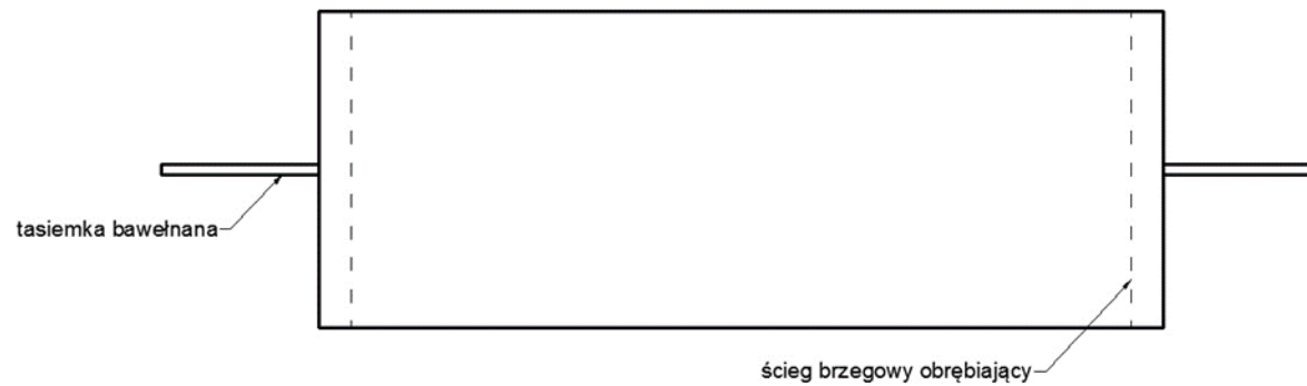
Rysunek 1. Sposób przeszycia krótkich boków poszewki, z wszyciem tasiemek bawełnianych służących do zamykania poszewki.
