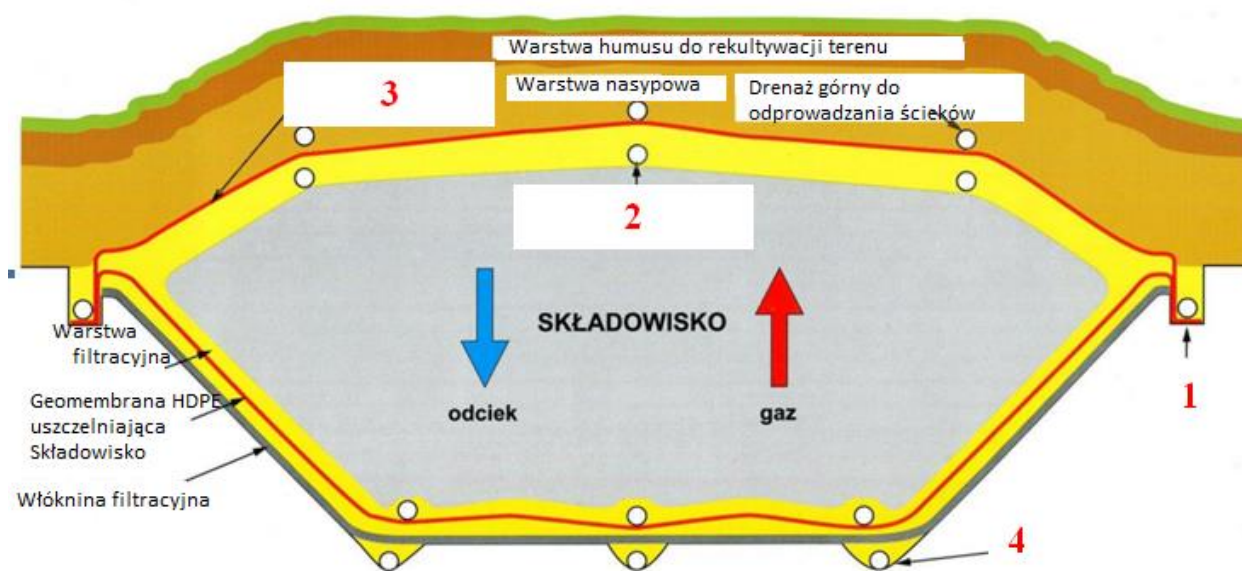
Przekrój składowiska odpadów
