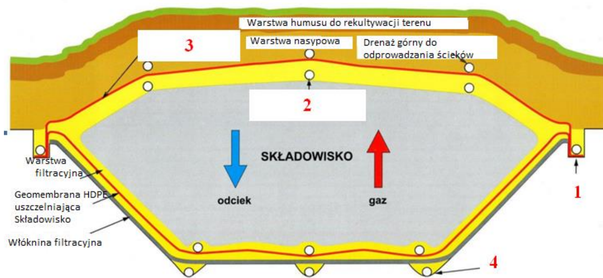
Przekrój składowiska odpadów
