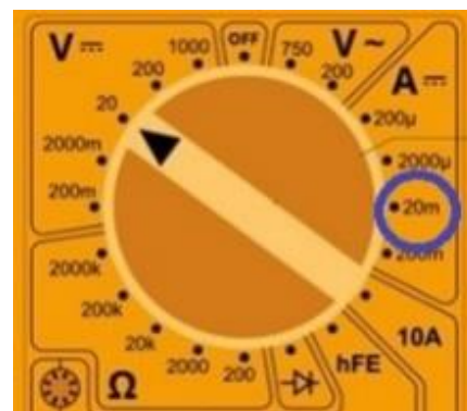
Rys. 2 Sposób zaznaczania ustawienia przełącznika multimetru. W przykładzie do pomiaru natężenia prądu w zakresie do 20 mA
