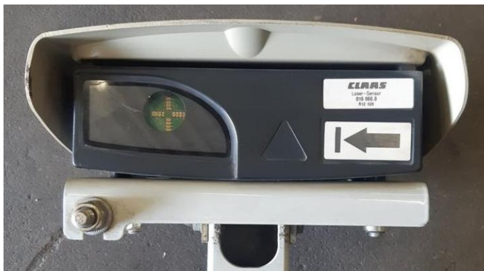
Ilustracja 1. LASER PILOT zastosowany w kombajnie.
